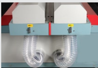
Dampner de regulagem de exaustão
